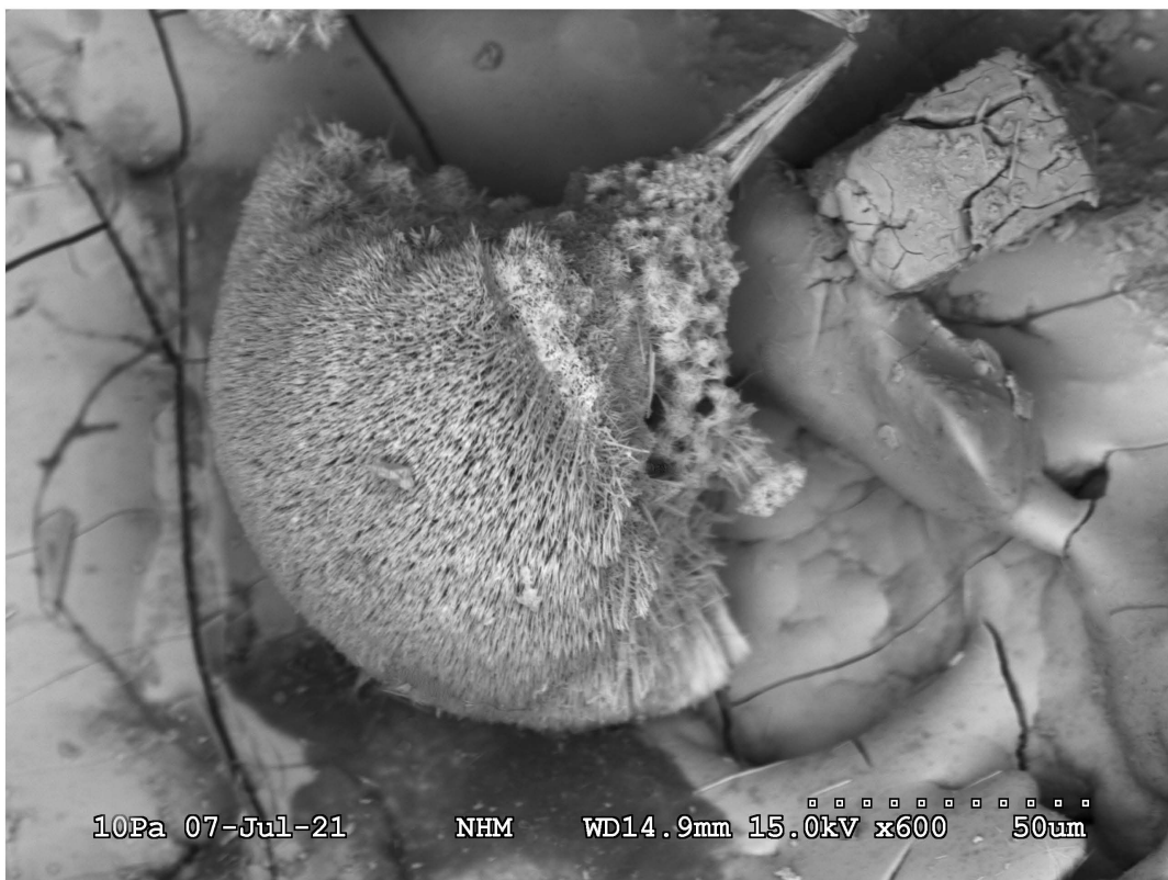
Figur 3. SEM-bilde av et divergerende aggregat av carlosbarbositt fra Eyje/Iceland. Legg merke til at krystallstørrelsen varierer, og at de eldste krystallene er størst. Den tetragonale krystallen oppe til høyre er thoritt.
