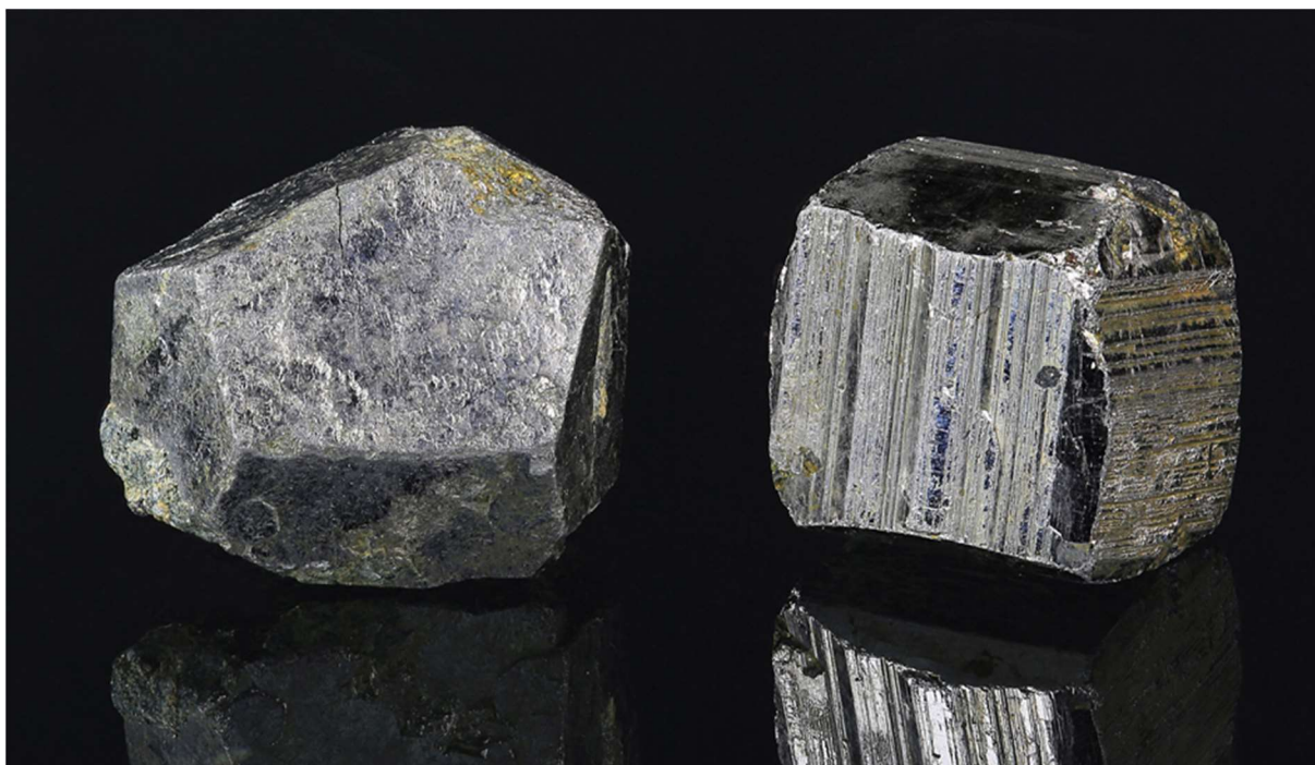
Figur 2. To krystaller av koboltitt fra Skuterud-gruvene, Snarum. Største krystall er 12 mm. Den til venstre er dominert av pyritoederet \{210\} og den til høyre dominert av heksaederet \{100\} , med dyp striping på disse flatene. Foto og samling: Øivind Thoresen.
