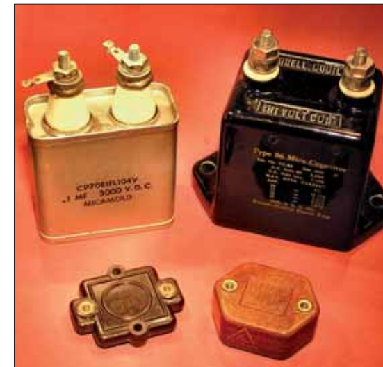
Glimmer-kondensatorer tåler svært høye vekselspenninger og -strøm og er meget viktig i bl.a. radio- og fjernsynsendere.
