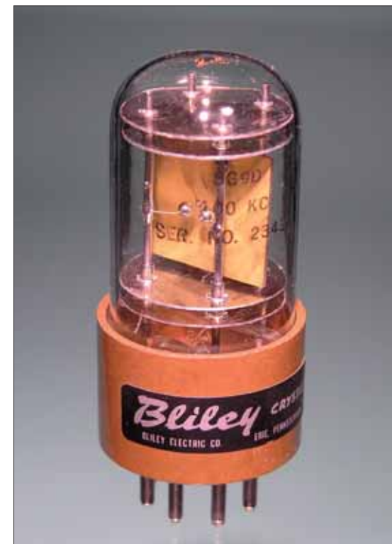
Glimmer i piezoelektrisk kvartsresonator. For å montere og holde både elektrodene og kvartsskiven på plass brukes det helst glimmer. Også i elektronrør ble glimmer brukt på akkurat samme måte.
