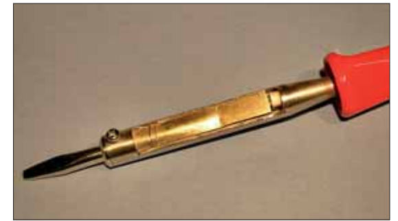
Loddebolt - Clas Ohlson; rundt varmelementet i slike loddebolter brukes det glimmer for unngå at utsiden av bolten blir overopphetet og at mest mulig varmet ledes til spissen.
