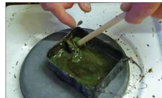
Figur 8: Lakken bygges opp før dopping. Foto: Jan Stenløkk.
