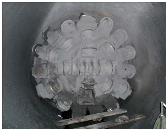
Like under senter på borhodet skimtes det firkantete mannhullet vi måtte gjennom.
