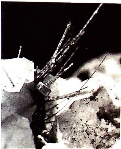
Nålformede cosalittkrystaller som gjennomsetter en tykktavlet kalkspat-krystall. Cosalitten sitter på en matrix av kalkspat og blyglans. De lengste nålene er 1 cm lange. Fra Skjensdistriktet.
