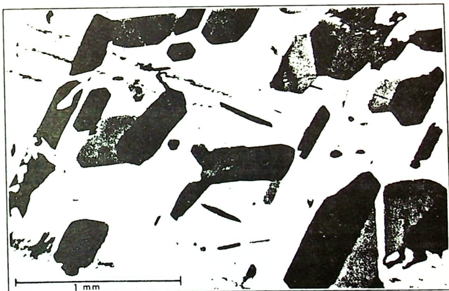
Tynnslip som viser hematittlamellene (hematittkrystaller) i solstein fra Åmland, Søndeled. Fra Andersen (1915).
