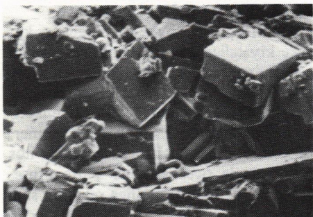
Thomsenolitt-krystaller. SEM-bilde 330 ganger forstørret. Elektronmikroskopisk lab. for biol.fag, Oslo Univ. Utlånt av Gunnar Raade).
