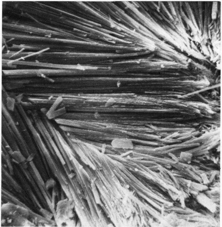
Fig. 2. Detalj av studtitt-vifte, Bjertnes. Scanning-elektronmikrografi (1050 ganger forstørret).
