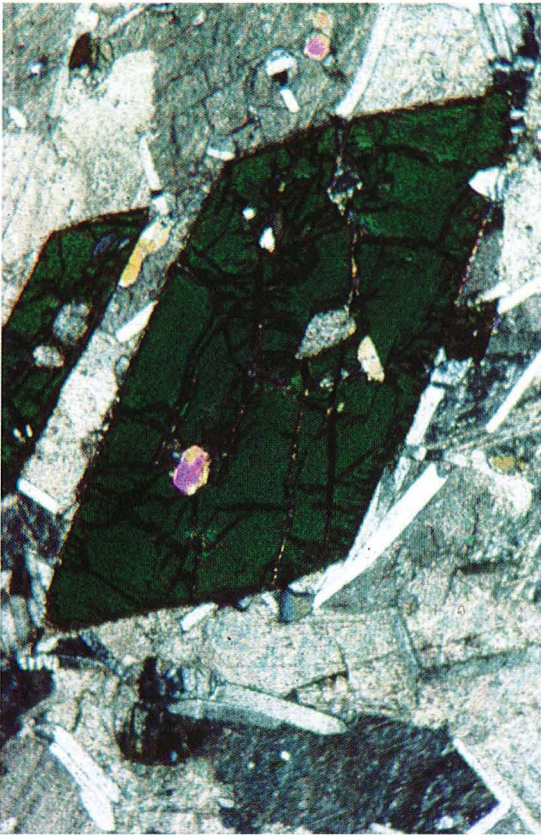
Orthorombisk tversnitt av ludwigittnål. Lengste diagonal er 2 mm. Mikroskopbilde.
