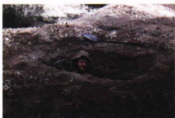
Handsänkning av opalgruvschakt, Lightning Ridge.
