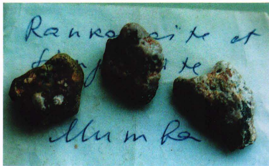
Plumbomikrolittklumper (7 - 10 gram) med inneslutninger av rankamitt og simpsonitt. Mumba Zaire.
