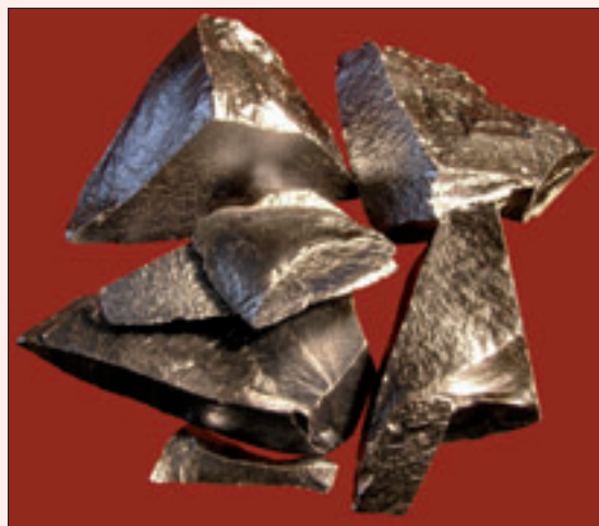
Ultra-ren silisium som brukes til fremstilling av databrikker og solceller.
