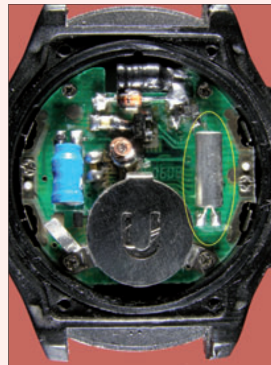
Digital kvartsklokke med miniatyr piezoelektrisk kvartskrystall.
