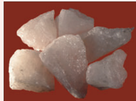
Ultra-ren kvarts som brukes til fremstilling av silisium til produksjon av databrikker og solceller.
