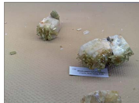
Et eksempel på hva som kan skje under ugunstige oppbevaringsforhold. Denne prøven har eksplodert på grunn av indre spenninger og høy temperatur inne i monteret.
