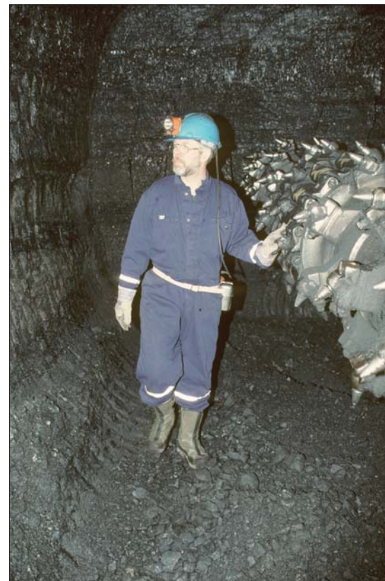
Kullaget i Svea Vest var opptil 5 meter tykt, men med et skiferlag i midten. Bergmester Johs. Vik.
