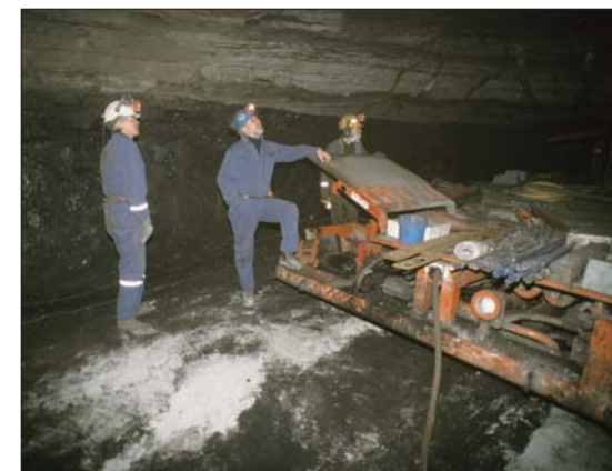
Longyearfløtsen i Gruve 7 er opptil 2 meter tykk.
