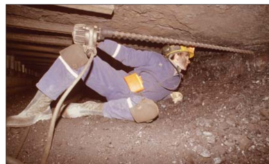
Kullaget i Gruve 3 var stedvis svært tynt og man måtte arbeide liggende.
