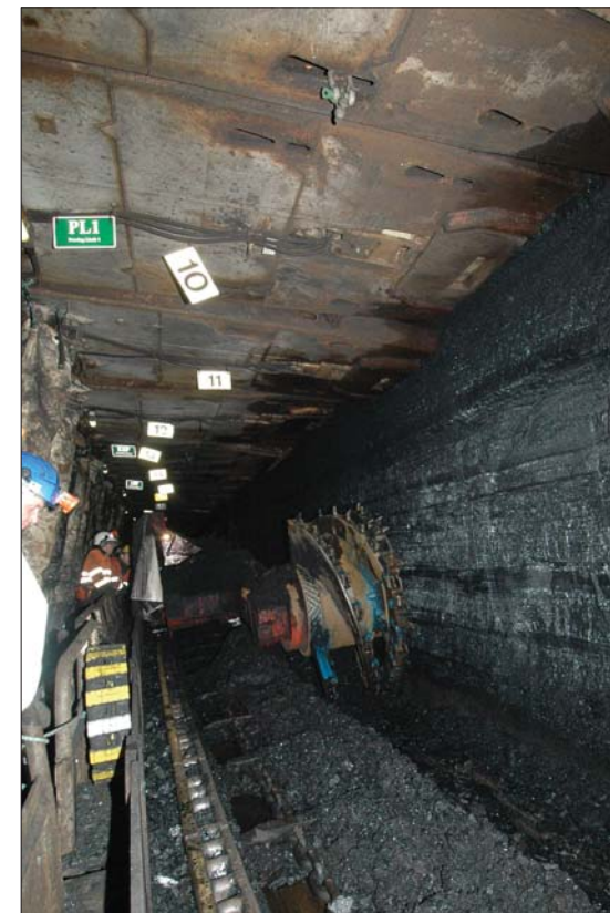
Kuttmaskinen inne på strossa i Svea Nord med trommelen med tennene som skaver ut kullet.
