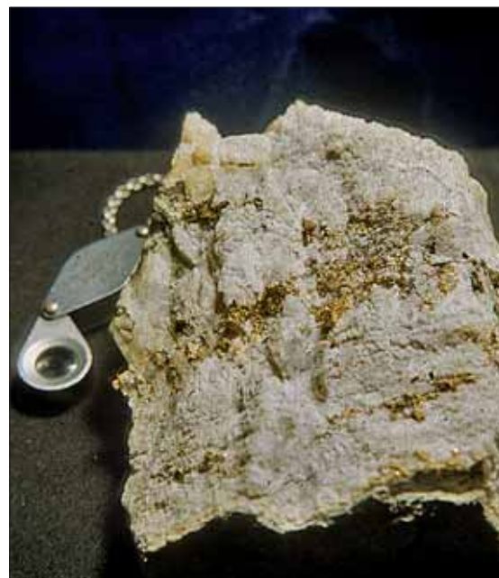
Flussyre har avdekket gullet.
