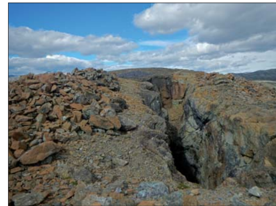
Loddrette sjakter uten sikring ved Verket kromittgruve.
