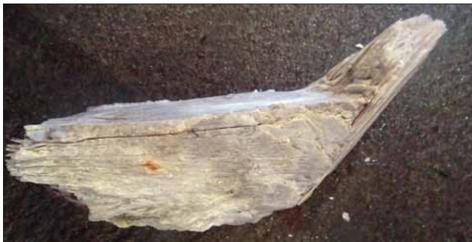
Skiferspatt som er hardt presset kalsitt i tynne lag. Lengde 35 cm, fra Kjenstad steinbrudd, Snåsa.
